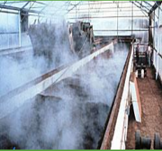
Traktörle itilen kendinden tahrikli (dizel motor) döner tamburlu-dövücülü namlu çevirici
