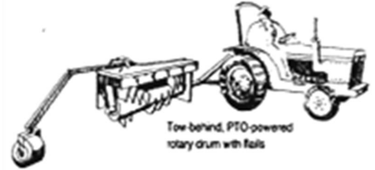
Arkaya asılır tip PTO tahrikli döner tamburlu dövücülü namlu çevirici
