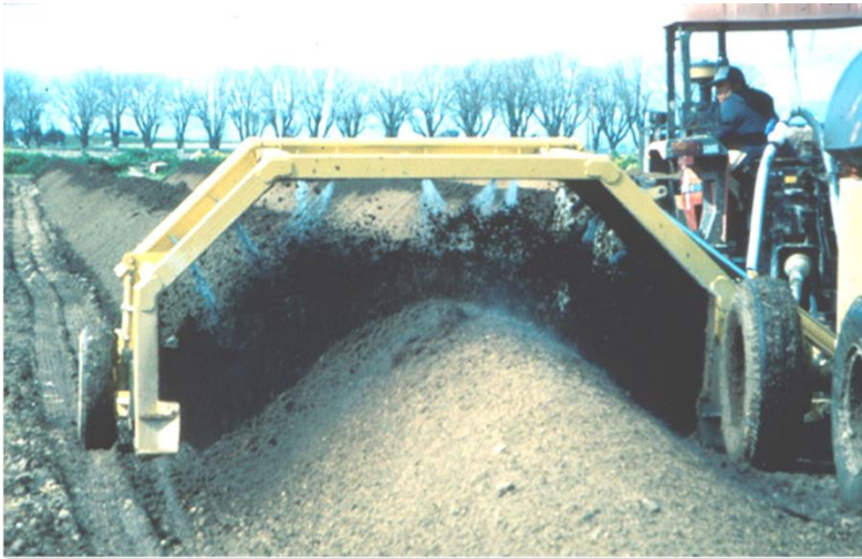
Traktörle çekilir tek geçişli bir namlu çevirme ekipmanı
