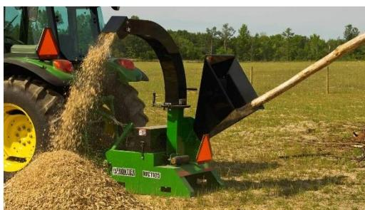
Şekil 18. Traktöre monte parçalayıcı (*Source: John Deer*)
